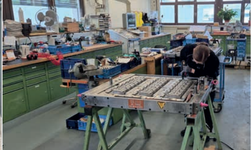
Bearbeitung Oberteil Kernformwerkzeug: schleifen und polieren
