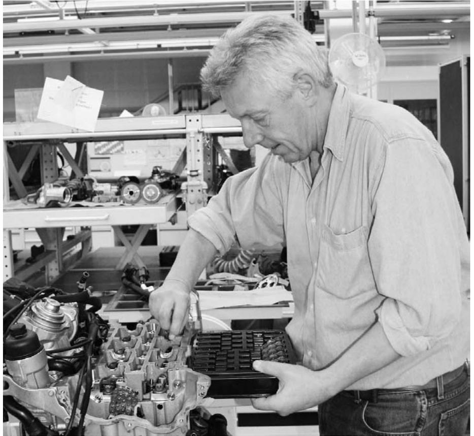
Die Motoren kommen nach der Montage zum Leistungstest auf den Prüfstand. Dann zerlegen Karl-Heinz Lenkeit und seine Kollegen den Motor, führen Messungen durch und montieren den Motor wieder
