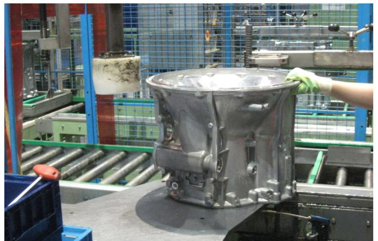
**Nachher:** Eine Bandschleife wurde angebracht - Gehäuseteil kann über leichtes Schieben zur Montagevorrichtung gebracht werden.
