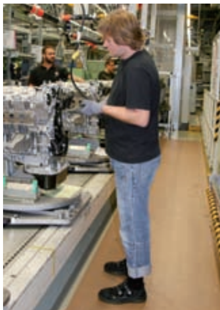
Die Montagekollegen sind zufrieden mit dem Holzboden, der Rücken und Gelenke schont
