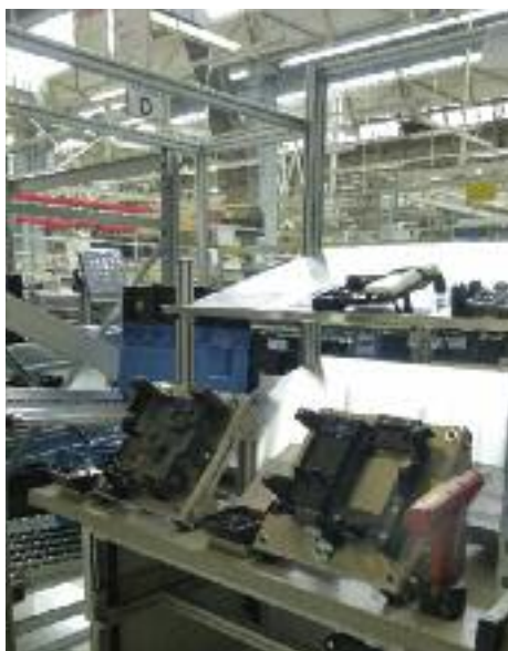
Entlastung. Das Arbeiten mit Schwerpunkt-Akkuschraubern auf einer 45 Grad ausgerichteten Arbeitsfläche vermeidet eine schlechte Körperhaltung bei den Vormontagetätigkeiten.
