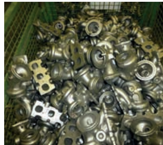
Hightech-Bauteil aus der Gießerei in Mettingen: Turbinengehäuse stehen bereit zur Weiterverarbeitung
