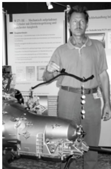
*Dieter Seemann mit seiner Erfindung „Ersatz Öleinfüllrohr durch Kunststoff-Überlaufrohr“. Durch das Überlaufrohr stellt sich der richtige Ölpegel automatisch ein. Das heißt, der Ölstand muss nicht mehr mit dem Ölpeilstab kontrolliert werden. Dieter Seemann arbeitet in der Entwicklung im Bereich EP/MTA. Dank seiner Idee spart die Firma bei jedem 7-Gang-Automatikgetriebe ein. (Dieter Seemann, Tel. 2 10 25)*
