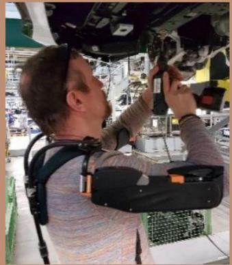
Bsp.: Exoskelett als Pilot-Versuch für Überkopfarbeit
